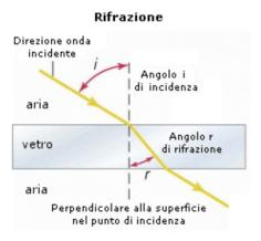
**Angolo di incidenza** è l'angolo fra l'onda incidente e la normale alla superficie di incidenza. L'angolo di incidenza è maggiore di 0° e minore di 90°
