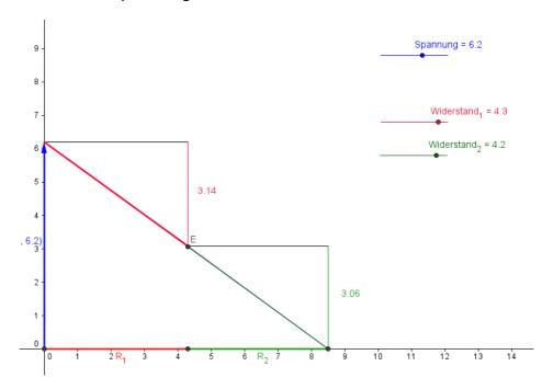
Mit dem Modell <u>SpannungsteilerLDR.ggb</u> lassen sich die Verhältnisse in einer Reihenschaltung bei Belichten eines LDR veranschaulichen.
