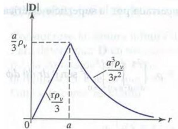
Figura 4.17. Diagrama de  $|\mathbf{D}|$  contra  $r$  en el caso de una esfera con carga uniforme.
