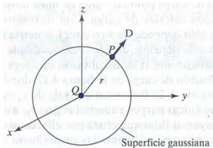
Figura 4.13. Superficie gaussiana alrededor de una carga puntual.
