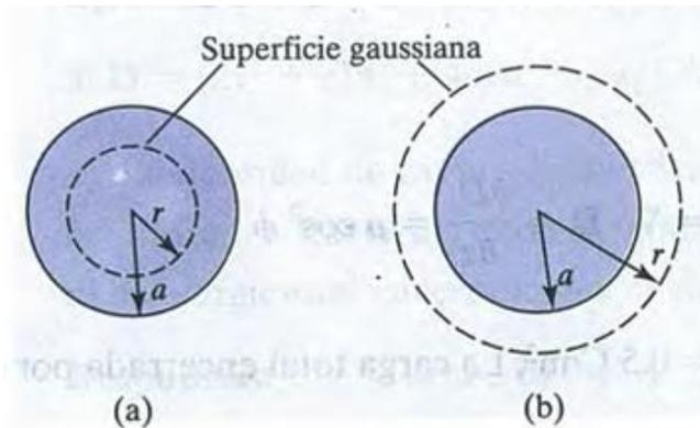
Figura 4.16. Superficie gaussiana para una esfera uniformemente cargada cuando: (a)  $r \geq a$  y (b)  $r \leq a$ .
