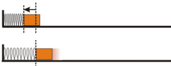
El muelle de la imagen vibra de manera horizontal. El bloque de madera situado al final del muelle sale disparado de manera horizontal. Tanto la vibración del muelle como el movimiento del bloque de madera son horizontales. La oscilación del muelle es un ejemplo de onda longitudinal.
